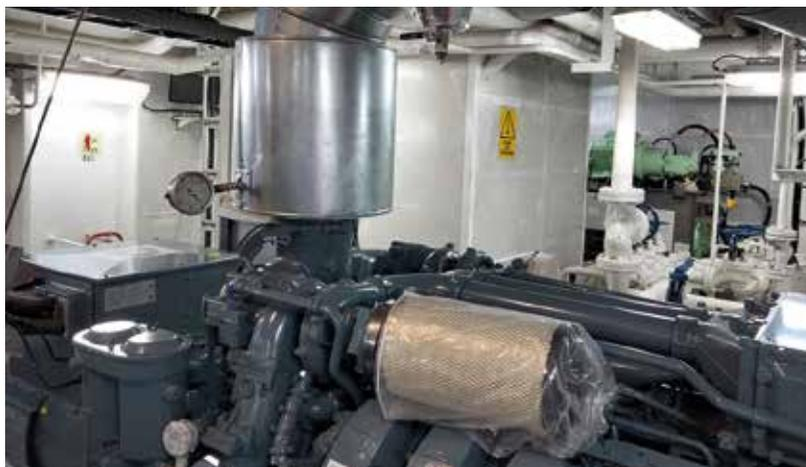
Colector de escape de motor auxiliar
