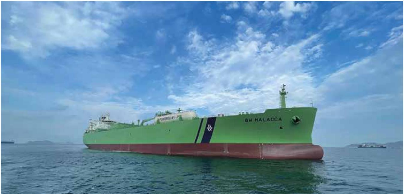
Buque dotado de motor dual capaz de operar con fuel oil y GLP
